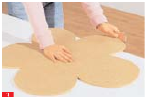
3 ... à la scie sauteuse. Poncez les escaliers presque inévitables que vous aurez faits lors du découpage des arrondis tout d'abord au papier de verre 80...
