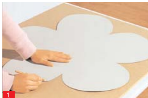
1 Découpez un patron en papier à la forme désirée. Choisissez les panneaux MDF les plus minces possible et reportez la forme au crayon.
