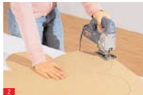
2 Découpez les formes dans les carrés de MDF, que vous aurez de préférence fait scier chez le fournisseur...
