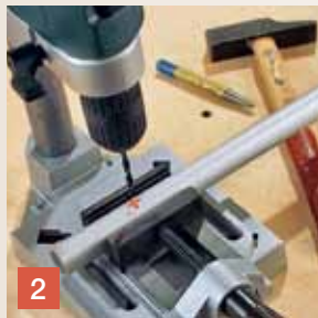
Foto 2 Bulinare il punto da perforare per una migliore presa della punta
