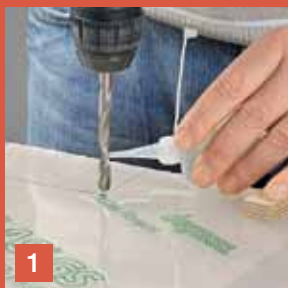
Foto 1 Raffreddamento: in caso di materiale sintetico utilizzare acqua corrente con un po' di detersivo
