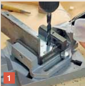
Foto 1 Le punte piccole possono essere raffreddate con l'aiuto di una bottiglietta di plastica
