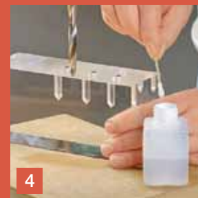
Foto 3 Perforare il plexiglas con una leggera pressione. Dal flusso di asportazione potete ...
