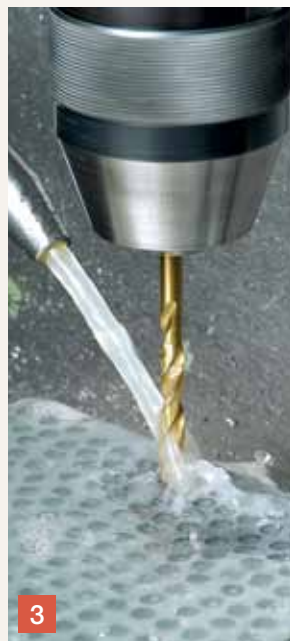
Foto 3 Il raffreddamento è fondamentale soprattutto per la durata delle punte
