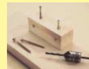
Cleveres Hilfsmittel: Direkt am Bohrer montierbarer Senker
