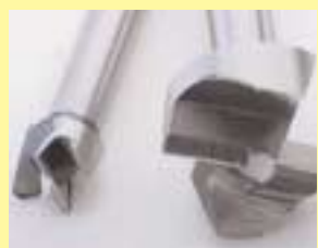
Schlechtes Zeichen: Grate deuten auf schlechte Verarbeitung
