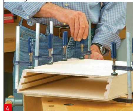
4 Adesso incollate la parte anteriore sugli elementi laterali e sul fondo. Utilizzate dei morsetti!
