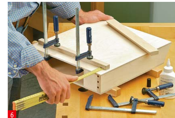
6 ...e incollate un listello da sostegno davanti e un listello di distanza dietro sotto l'elemento posteriore della valigetta.
