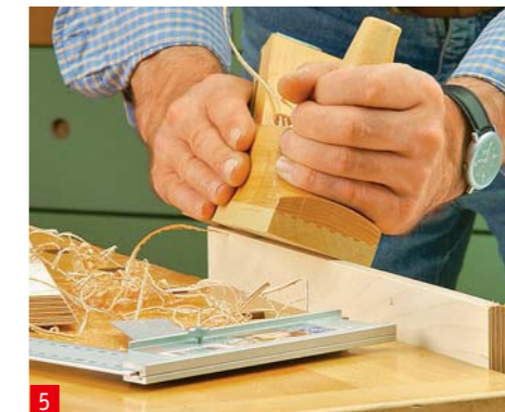
5 Dopodiché applicate con una pialla manuale un angolo di 30 gradi su entrambi i listelli da sostegno ...
