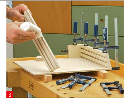
3 Dopodiché incollate i due elementi laterali e il fondo alla parte posteriore.
