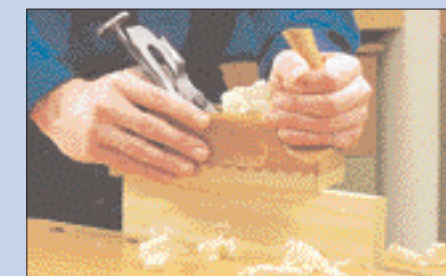
Den Hobel mit beiden Händen etwas schräg zum Werkstück ausrichten und in gleichmässigen Zügen über das Holz führen
