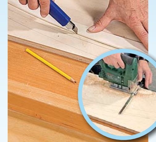
2 Segare una sagoma, trascrivere le misure due volte sul multiplex, scalfire leggermente con il taglierino e segare
