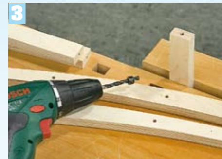
3 Trapanare dei fori ciechi nei punti corrispondenti degli archi laterali e dei listelli trasversali
