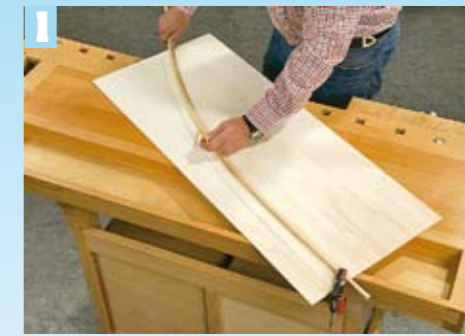
1 Realizzare una sagoma per gli archi laterali con un listello curvato e un foglio di compensato
