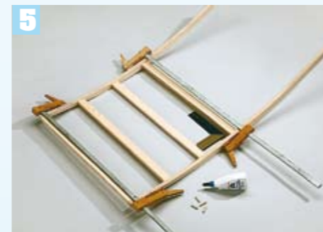
5 Incollare e tassellare innanzitutto il sostegno e in seguito i listellari. Importante: assicurarsi che l'angolo sia retto!
