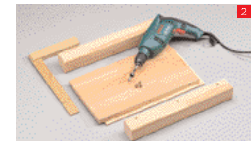
Per trasferire le posizioni dei tasselli attraverso i relativi fori, stendete le pareti laterali su una base con spessore 6,5 mm a causa degli spigoli arrotondati delle intelaiature trasversali.
