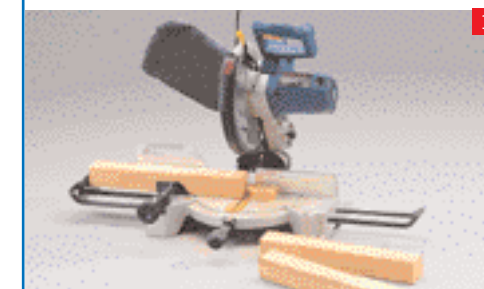
1 Wichtig: Die Schnitte, mit denen Sie die Systemrahmen ablängen, müssen rechtwinklig sein. Dazu brauchen Sie eine Kapp- und Gehrungssäge oder eine grosse Gehrungssäge
