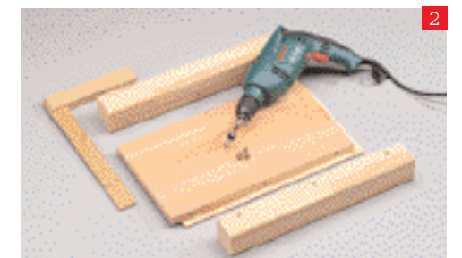
2 Legen Sie zum Übertragen der Dübelpositionen mittels Dübeln fixen die Seitenwände wegen der gerundeten Querzargenkanten auf eine 6,5 mm dicke Unterlage.
