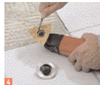
4 Togliere la lama per il metallo duro dalla segatrice a segmenti e...
