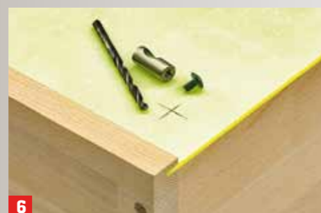
6 Setzen Sie die Plexiglasscheibe (3 mm) ein, markieren die Position des Möbelknopfes und bohren durch das Glas
