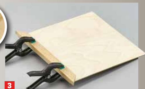
3 Das Reststück des gekürzten vierten Teils wird als Blend- und Griffleiste verwendet, die Sie auf das Sperrholz leimen
