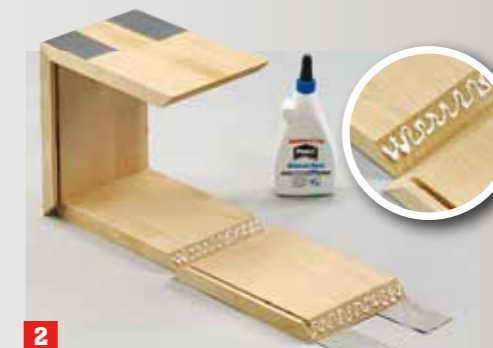
2 Die Teile zunächst mit Klebeband miteinander verbinden, Leim auf die Gehrungsschnitte geben und zusammensetzen
