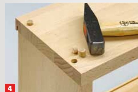
4 Gekürzte Holzdübel schlagen Sie mit dem Hammer in die vorgesehenen Öffnungen ein
