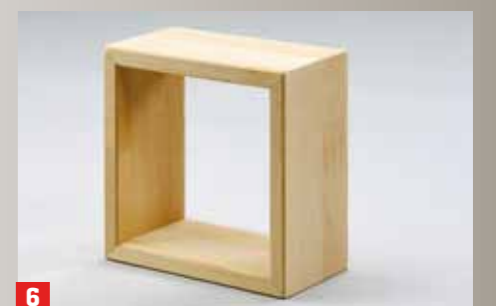
6 Anschliessend schleifen Sie die Holzoberflächen an und behandeln sie mit Klarlack oder Hartwachsöl
