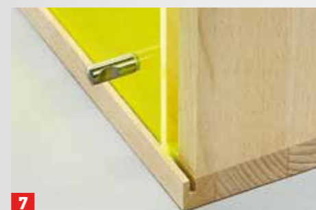
7 Schutzfolie entfernen, Möbelknopf montieren und Plexiglastür einschieben
