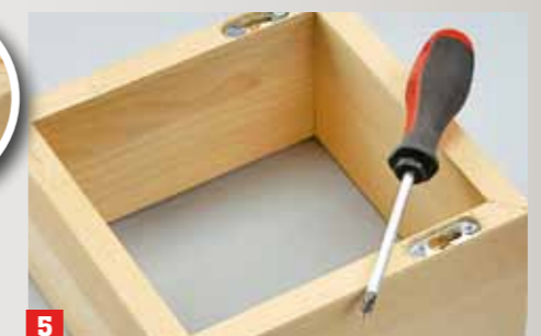
5 ... den Bereich ausbohren und die Aufhänger festschrauben
