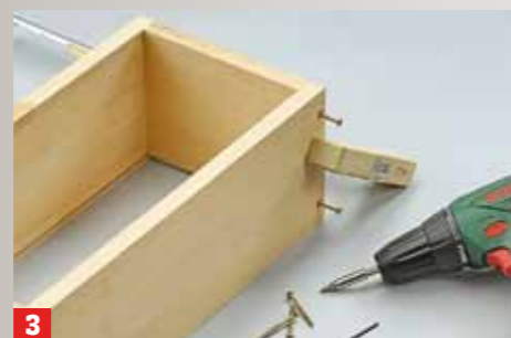
3 ... mit Klemmen zusammen und bohren durch die Löcher von Boden und Deckel in die Seitenteile. Teile verschrauben
