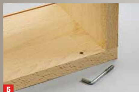
5 Die Regale können Sie mit Wandhaken aufhängen. Hierfür müssen zwei Löcher in die Deckelunterseite gebohrt werden
