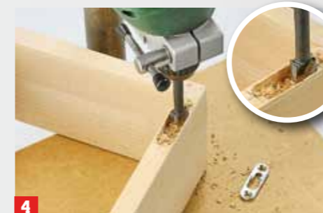
4 Als Halterung dienen Wandaufhänger, die in das Holz eingelassen werden. Dazu mit dem Forstnerbohrer ...
