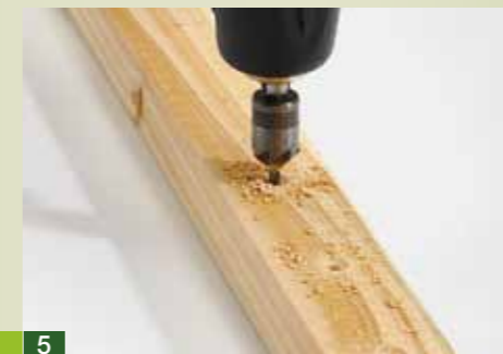
5 Il fondo è costituito da quattro assi. Sgrossare i fori per le viti e allargarli. Per evitare che il fondo si deformi...
