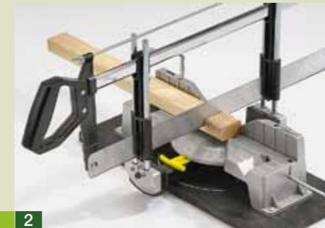
2 I listelli vengono uniti mediante incastro a mezzo legno. Pertanto praticare diverse incisioni nel legno fino a metà spessore...
