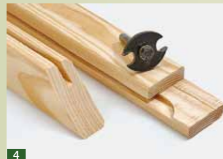
4 Le scanalature per l'inserimento delle lastre di vetro acrilico vengono realizzate con la fresatrice verticale e una scanalatrice a disco
