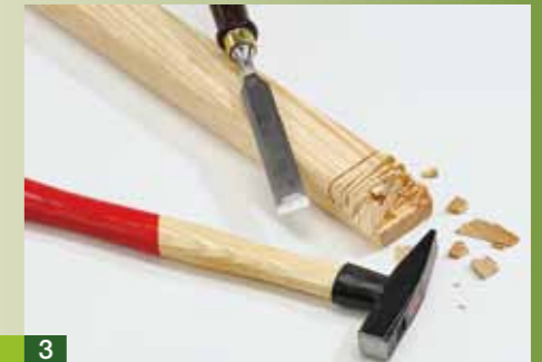
3 ... e con uno scalpello affilato e un martello mortasare il listello
