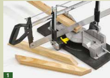
1 Tagliare i listelli di douglasia in base alle misure riportate nell'elenco dei materiali di pag. 94 e tagliarli ad angolo
