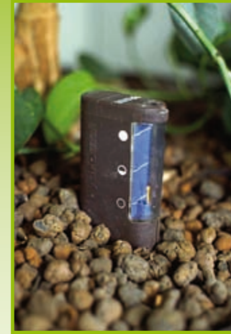
Indicatore del livello dell'acqua nel substrato d'idrocoltura
