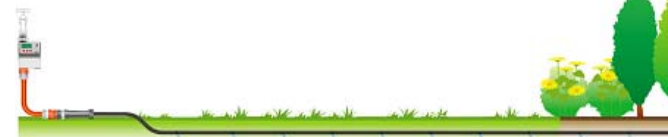
Le tuyau goutte à goutte enterré convient pour l'arrosage de gazon et de platebandes. Lors de réaménagement de votre jardin, vous devriez impérativement prendre en considération cette forme d'arrosage.
