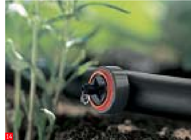
14 Goutteur de précision: autorégulant, autonettoyant, fermeture automatique. Recommandé pour de longues conduites équipées de goutte à goutte ainsi que pour les talus.
