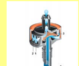
Système Micro-Drip à goutteurs de précision 2l/h; autorégulant, autonettoyant, fermeture automatique. Usage recommandé: goutte à goutte pour longueur importante ainsi que pour les talus.
