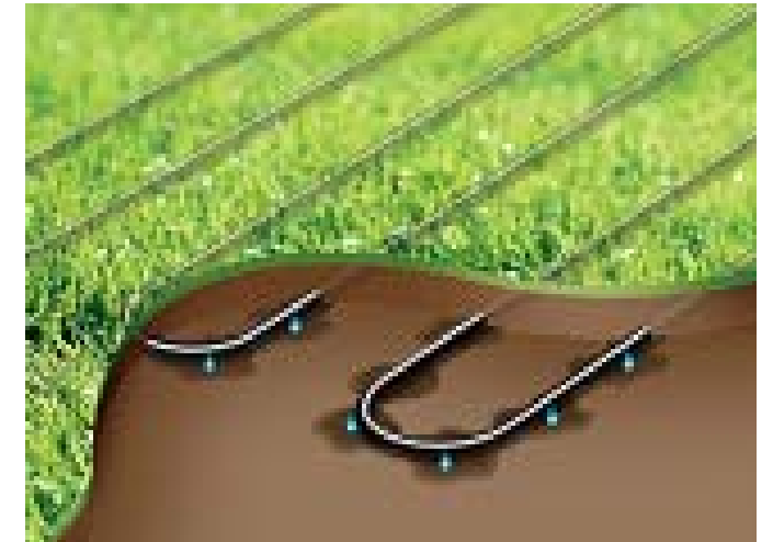
Le tuyau goutte à goutte enterré convient pour l'arrosage de gazon et de platebandes. Lors de réaménagement de votre jardin, vous devriez impérativement prendre en considération cette forme d'arrosage.
