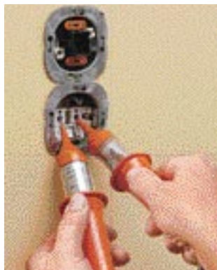
Duspol: la mesure se fait entre deux pôles, le résultat est directement visible.
