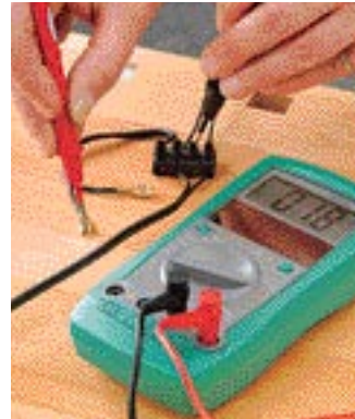
Multimeter sind erheblich vielseitiger, jedoch aufwendiger in der Nutzung
