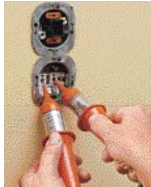
Duspole: Gemessen wird zwischen zwei Polen, das Ergebnis ist direkt sichtbar
