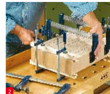
2 Applicare la colla per legno sulle superfici e pressate tutte le parti in legno con i morsetti.
