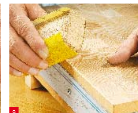
9 Lisciate gli spigoli dell'asse utilizzando carta abrasiva a grana 120.
