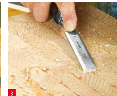
3 Togliete la colla non ancora seccata che fuoriesce con uno scalpello.
