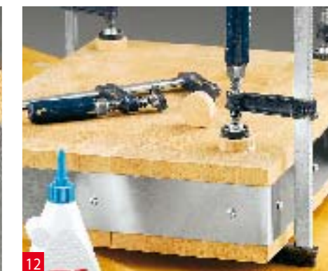
12 Come base utilizzate quattro tasselli trasversali che vanno incollati alla parte inferiore. Pressate coi morsetti.
