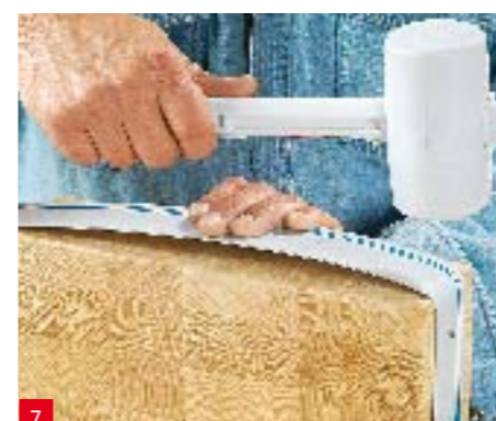
7 Avitate le strisce di metallo, piegate sugli spigoli e batteteci sopra con il martello.
