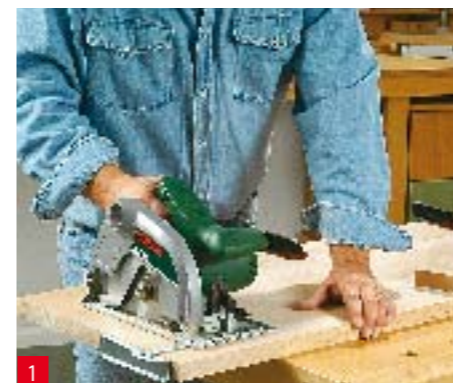
1 Tagliate il legno di faggio in strisce grandi uguali con la sega circolare a mano e una squadra a cappello.
