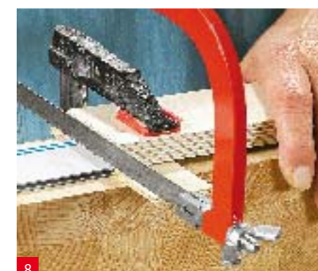
8 Trapanate e avitate di nuovo. Tagliate la fine della striscia con la sega di metallo.
