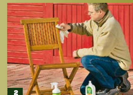
2 Dopo la pulizia il legno duro dovrebbe essere trattato con un olio o un prodotto adatto.
