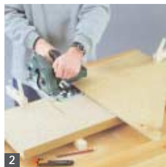
2 Utilizzate la sega circolare e la guida di arresto, affinché le incisioni risultino molto precise.
