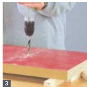
3 Perforate ora al centro della linea l'incisione dello spigolo anteriore un foro di 10 mm, nel quale inserire la lam
