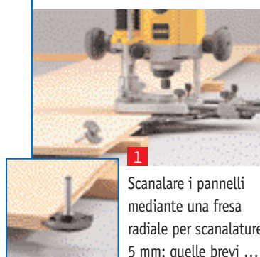
2 ... in modo continuo, quelle lunghe in modo intermittente. Congiungete i pannelli con linguette da listelli di 5 x 20 mm.
