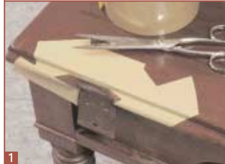
1 Prima misura: ricoprite con cura il punto danneggiato con nastro per pacchi. La stessa cosa vale tra l'altro anche ...
