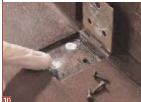
10 ... capovolgete il tavolo. Con il mastice per riparazioni formate sottili salsicce che introdurrete nei fori per le viti premendo con forza.
