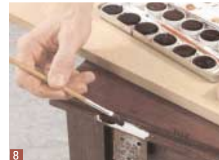
8 Diluite l'inchiostro di china per ritocchi con dello spirito e mescolate fino ad ottenere la tonalità desiderata. Testate su un resto di mastice Power asciutto.
