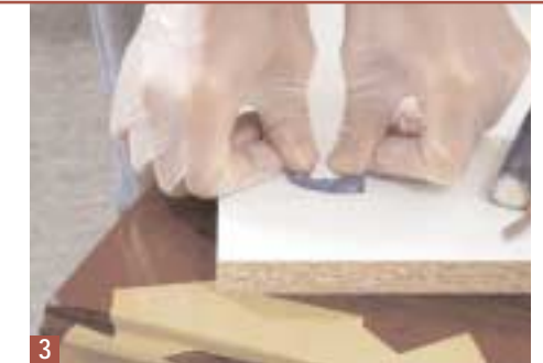
3 Infilate dei guanti in lattice e ritagliate una fetta di mastice per riparazioni bicomponente. Mescolate le due masse colorate, ...
