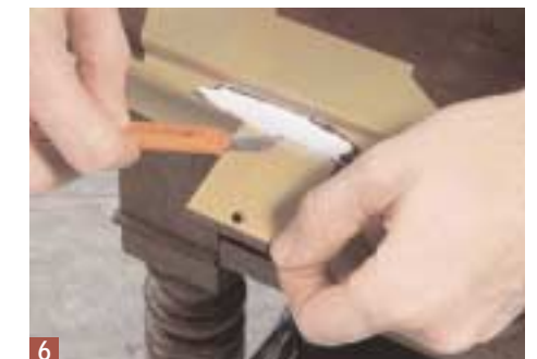
6 Quando la resina si è indurita del tutto svitate il pezzo di legno che fungeva da supporto alla cerniera. Con un taglierino tagliate il nastro per pacchi.
