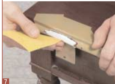
7 Se il risultato ottenuto non è del tutto soddisfacente, levigate con cautela la superficie indurita del mastice con della carta vetrata di grana 180.
