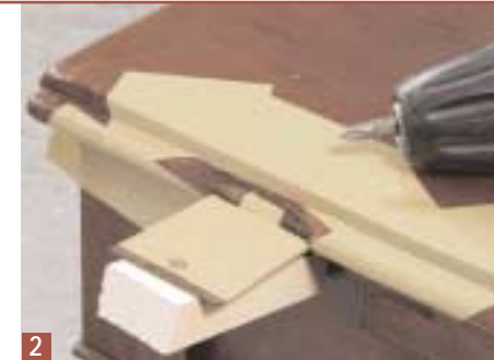
2 ... per la parte staccatasi della cerniera e l'area centrale che elaborerete. Fissate la cerniera con una piccola vite su un pezzo di legno di scarto.
