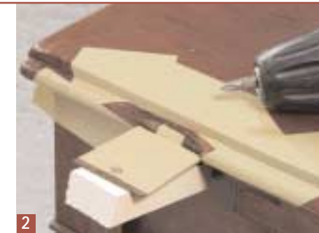
2 ... lösen Teil des Scharniers und den Mittelteil des sogenannten Gewerbes. Scharnier mit einem Schraubchen auf einem Stück Restholz fixieren
