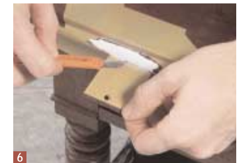
6 Nach dem Aushärten der Knetmasse schrauben Sie das Holzklötzchen los. Durchtrennen Sie mit dem Cutter das Paketband am Gewerbe
