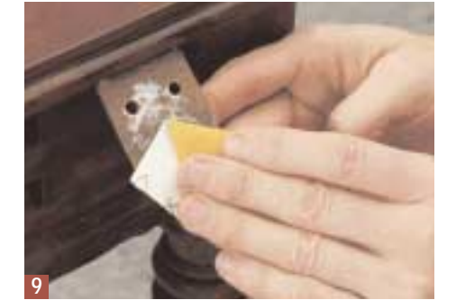
9 Farbe zügig und etwas über die Ränder hinaus auftragen. Vor der Montage sollten Sie noch das Scharnier etwas entrosteten. Stellen Sie nun ...
