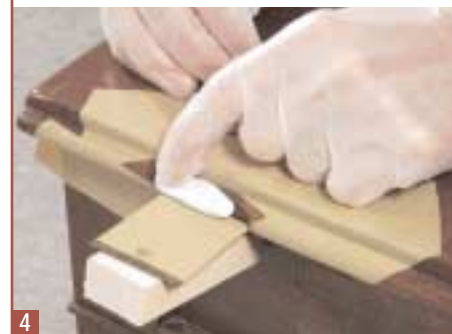
4 ... bis sie ganz weiss ist. Dann haben Sie 5 Minuten Zeit, um die Knete tief, fest und bis in die Winkel in die schadhafte Stelle hineinzudrücken
