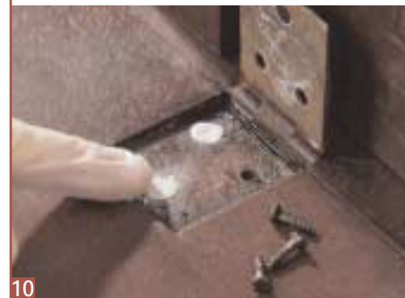
10 ... den Tisch auf den Kopf. Aus der Reparaturknete dünne Würste formen, in die Schraubenlöcher einführen und kräftig darin festdrücken
