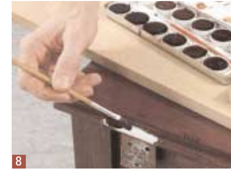
8 Lösen Sie Retuschiermasse mit Spiritus an, und mischen Sie den passenden Farbton. Auf einem Reststück getrockneter Power-Knete testen
