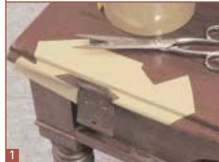
1 Erste Massnahme: Kleben Sie die ausgebrochene Stelle sorgfältig und möglichst eng mit Paketband ab. Das gilt übrigens ebenso für den ...
