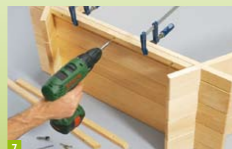
7 ...forateli di sgrasso e fissateli con una colla poliuretanicca e i morsetti e, successivamente con delle viti inossidabili per pannelli truciolari.
