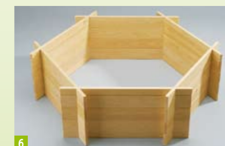
6 Procedere anche per il corso superiore dimezzando in altezza una tavola su due. Ricavare i listelli di finitura per le tavole di copertura,...
