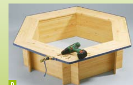
9 Incollare insieme le tavole di copertura con un tassello piano, pressare con una cinghia di tensione e avvitare dal basso. Rivestire eventualmente le pareti laterali con della pellicola per stagni o laghetti.
