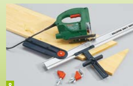
8 Abbiamo tagliato le tavole di copertura utilizzando una barra di battuta per seghe a gattuccio e circolari.
