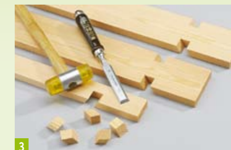
3 Posizionare lo scalpello sulla linea trasversale. Un leggero colpo con il martello di plastica è sufficiente per...
