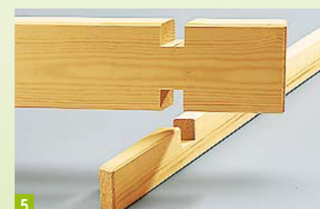
5 Ora è possibile assemblare le tavole delle pareti laterali. Corso inferiore: infilare sempre una tavola intera in una mezza tavola.
