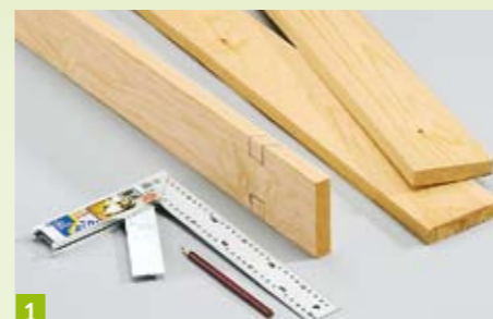
1 Segnare gli intagli sulle tavole laterali. Utile: una squadra professionale dotata di una linguetta pieghevole.
