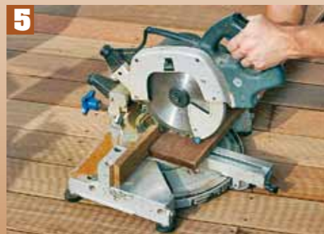
5 Une scie à déliner et à onglet est une aide précieuse pour scier à la longueur voulue le bois équarri et les planches extrêmement durs.
