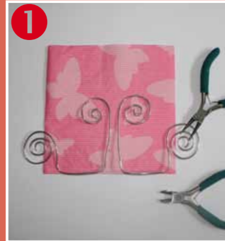
Bild 1 Mit dem Seitenschneider ein etwa 70 cm langes Stück vom Aludraht 2.0 mm abschneiden und mit Hilfe der Rundzange Spiralen bilden. Vier Stück dieser Doppelspiralen fertigen.
