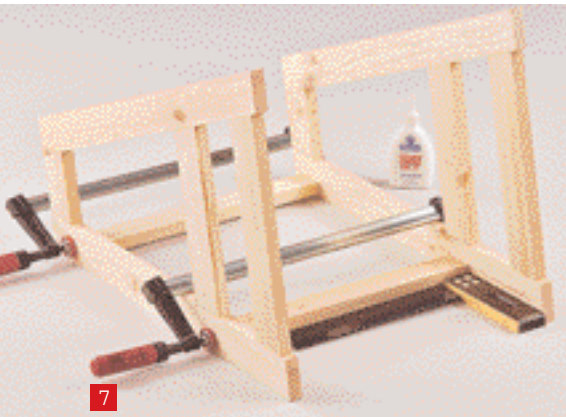
7 Leim in die Stützenlöcher geben; Verbindungen festzwingen. Achten Sie dabei auf Rechtwinkligkeit
