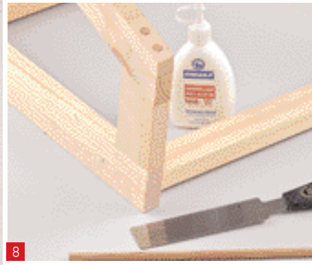
8 Nun Dübellöcher bis in die Querverbinder durchbohren. Dübel einleimen, kürzen und beis Schleifen
