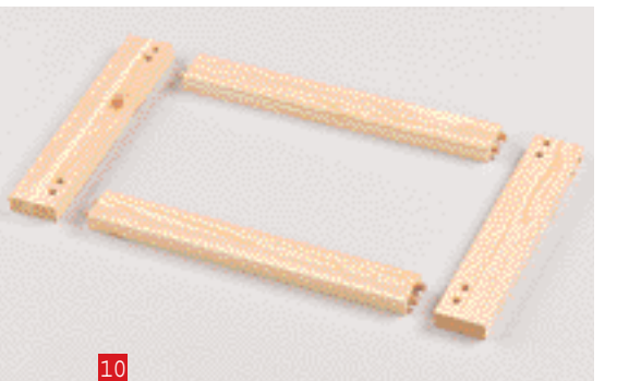
10 Dübeln Sie auch den Rahmen aus Längsstreben und Eckstützen (das sind die Beine der Stufe)
