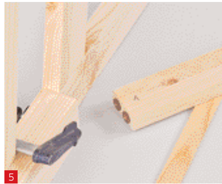
5 Beim Markieren der Positionen Längsverbinder auf 5-mm-Leiste legen, da diese zurückgesetzt liegen
