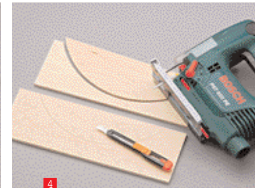
4 Incidete le linee con il taglierino prima di ritagliare gli archi con la sega a gattuccio.
