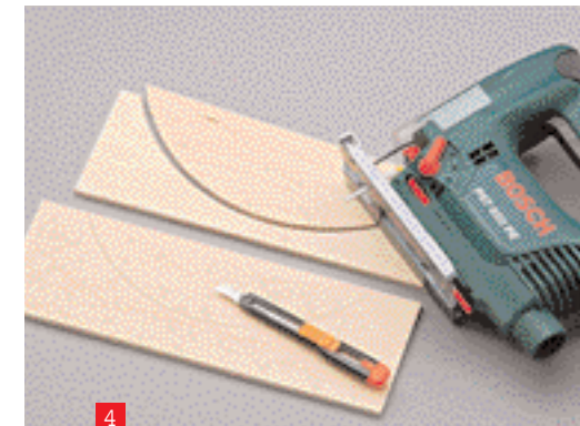
4 Ritzen Sie die Linien mit dem Cutter an, bevor Sie die Bögen mit der Stichsäge ausschneiden
