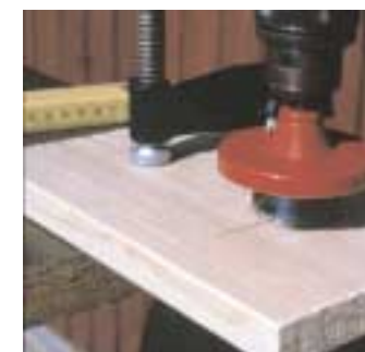
Pour percer le trou d'envol, le mieux est d'utiliser une scie à guichet, un outil qui s'adapte à n'importe quelle perceuse.
